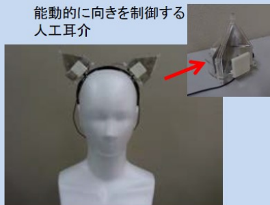
動物の耳介(耳たぶ)を模した反射板による音源方向の推定ロボット
