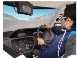
図1 注視点距離の実時間計測による注視点依存型モデルの推定
