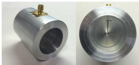
図1. 広帯域な特性を持ち、広角な範囲で円偏波を放射する導波管形アンテナ
