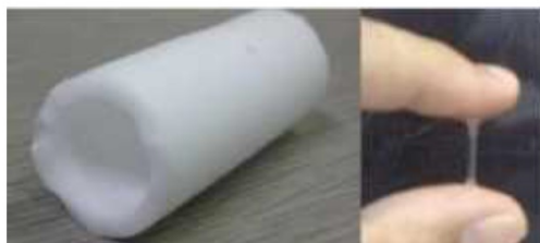
図2 生体関節の機能を模倣したベアリング
