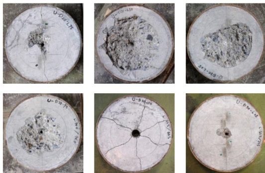
図1 引抜き試験後の接着系あと施工アンカー
