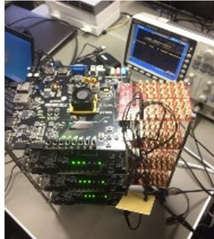
4枚のFPGA基板により構築した簡易版三次元積層LSIシステムエミュレータ (開発中)
