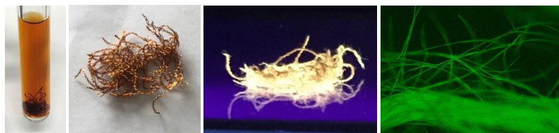
左から反応液、その後洗浄した糸、紫外線ランプによる蛍光、蛍光顕微鏡下での観察 (FITCフィルター：488 nm励起)
